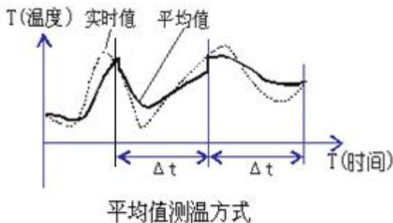
可以通过按键设置平均值的的时间。仪器在一个选定时间间隔  $\Delta t$  内计算并显示实时值变化中的平均值。采用了一阶 RC 的算法，可以减少温度的波动。
