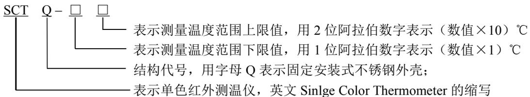
示例：SCTQ-080 表示测量温度范围为 0°C~800°C，外壳为不锈钢的固定安装式单色红外测温仪。
